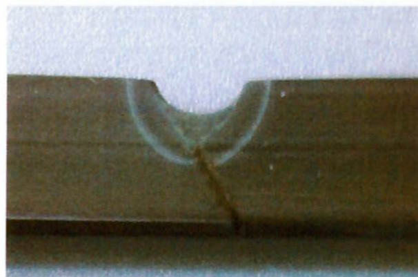
Figura 27 - CP2 Ensaio Tekken utilizando ER110S-1.
