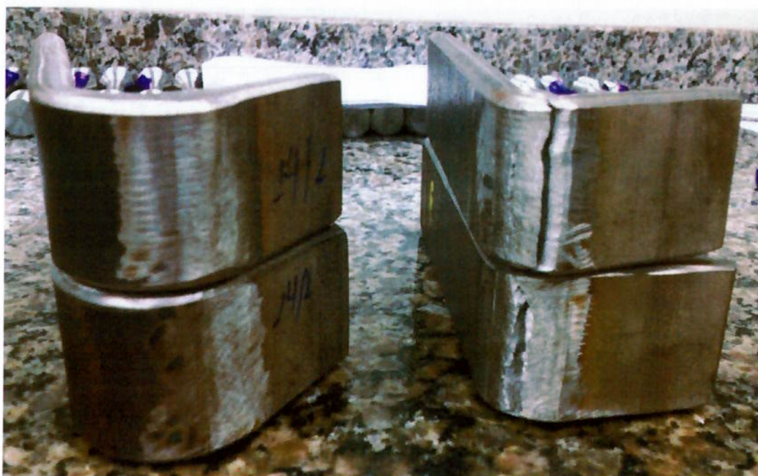
Figura 43 - Corpos de prova de dobramento utilizando ERNiCrMo-3.
