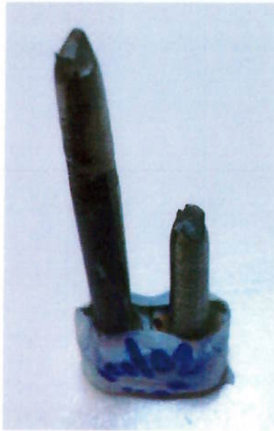
Figura 37 - CP1 do ensaio de tração utilizando ERNiCrMo-3.
