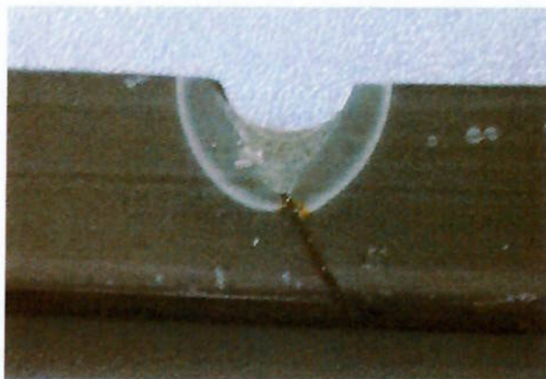
Figura 29 - CP4 Ensaio Tekken utilizando ER110S-1.
