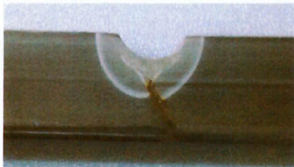
Figura 26 - CP1 Ensaio Tekken utilizando ER110S-1.
