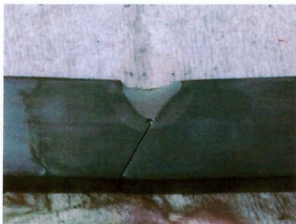
Figura 31 - CP1 Ensaio Tekken utilizando ERNiCrMo-3.
