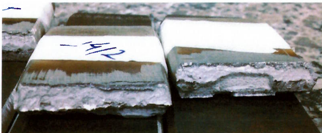
Figura 40 - Detalhe dos corpos de prova de dobramento do lado da superliga à base de ferro endurecível por precipitação.
