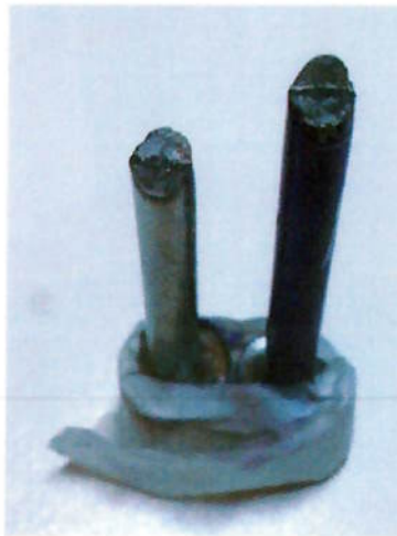
Figura 38 - CP2 do ensaio de tração utilizando ERNiCrMo-3.
