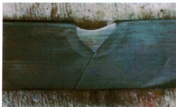
Figura 32 - CP2 Ensaio Tekken utilizando ERNiCrMo-3.
