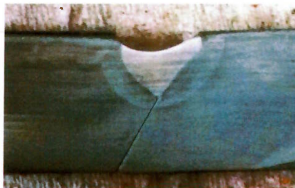
Figura 33 - CP3 Ensaio Tekken utilizando ERNiCrMo-3.
