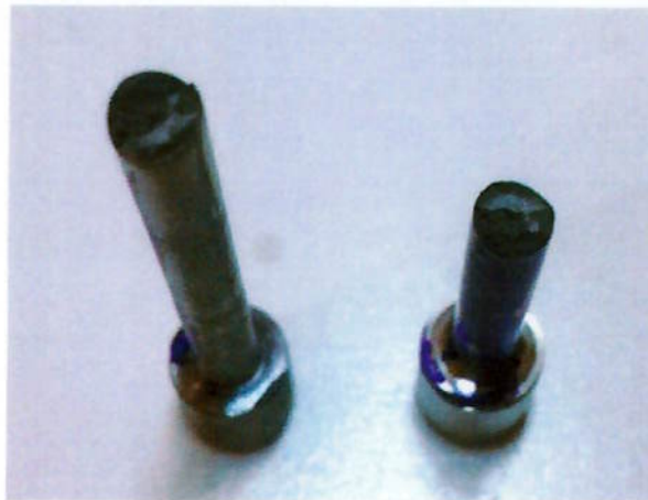
Figura 36 - Figura 31 - CP2 do ensaio de tração utilizando ER110S-1.
