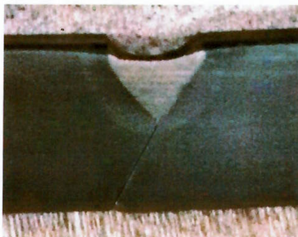
Figura 34 - CP4 Ensaio Tekken utilizando ERNiCrMo-3.
