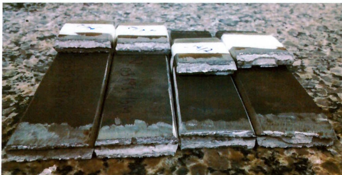
Figura 39 - Corpos de prova rompidos após o ensaio de dobramento utilizando ER110S-1.
