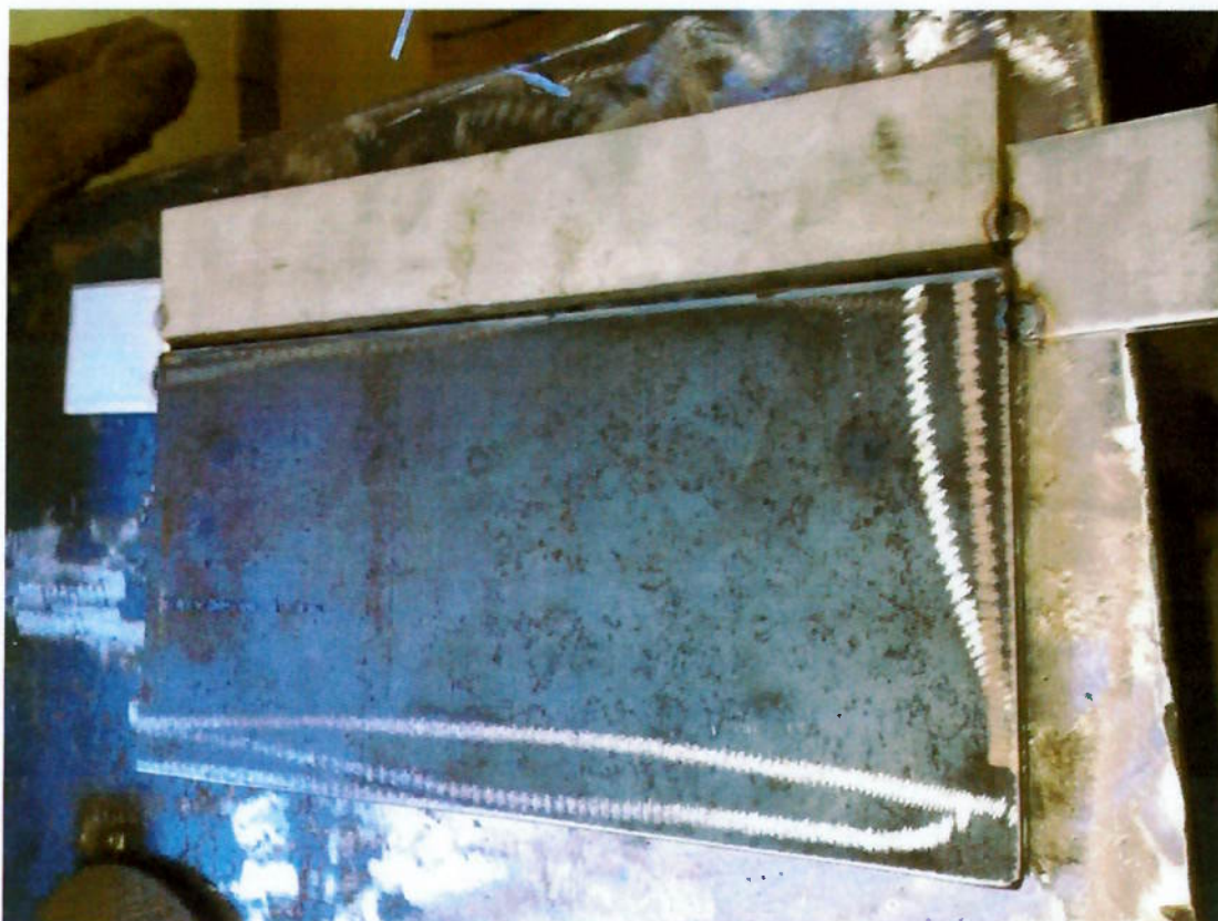
Figura 19 - Chapas de USI SAR 80-T e ASTM A453 Gr 660 montadas para soldagem.
