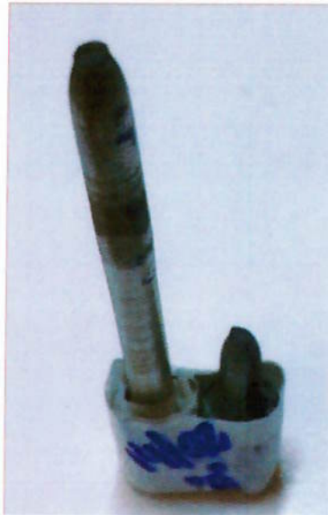
Figura 35 - CP1 do ensaio de tração utilizando ER110S-1.
