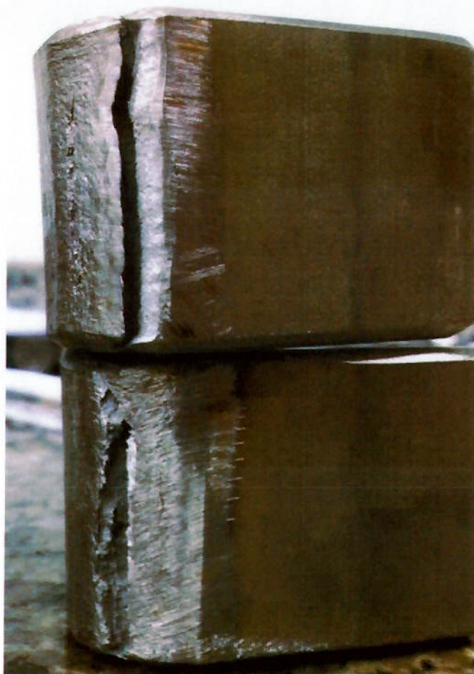
Figura 44 - Detalhe dos corpos de prova de dobramento soldados com ERNiCrMo-3.
