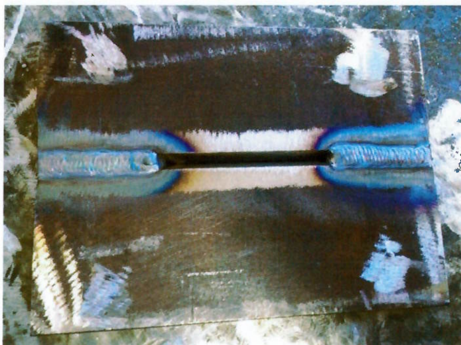
Figura 15 - Soldagem de restrição com o eletrodo nu ER110-S1.
